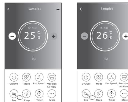
1. Для активации функции SMART ECO просто нажмите на кнопку, кнопка загорится, на экране появится вентилятор.
