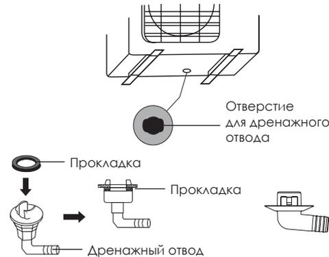
**Примечание:** изображение конструкции дренажного патрубка приведено для справки. Конструкция дренажного патрубка вашего кондиционера может отличаться (например, может отсутствовать резиновая прокладка).
